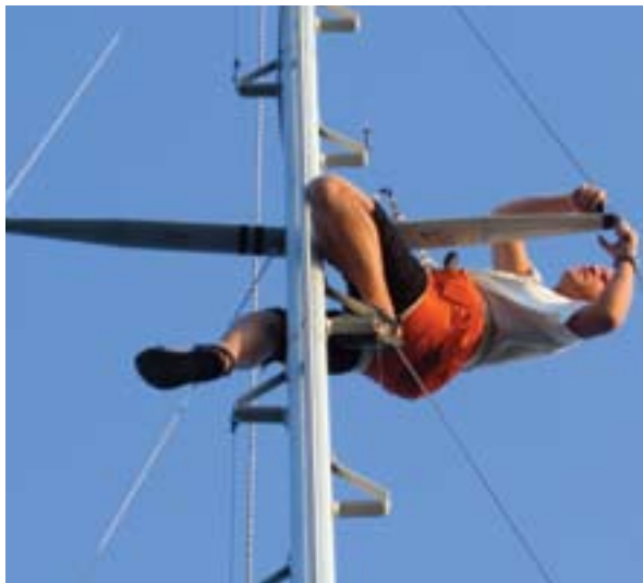
Med masten på plass ble alle splinter, sikringer og slitepunkter dobbeltsjekket og polstret. En viktig jobb, både for å unngå rigghavari og søvnløshet.
